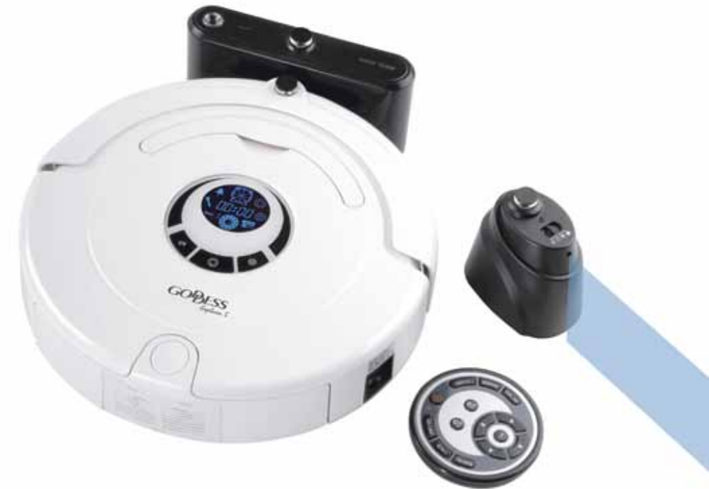
Nejvyšší model Goddess CL590W (9.900 Kč) má mimo jiné i větší nádobu (0,37 l) a delší dobu provozu (100 min). Vpravo vidíte tzv. virtuální stěnu sloužící k omezení pohybu vysavače podle vašich potřeb.
