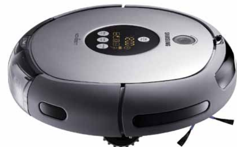
Samsung SR8845 (10.990 Kč) má stejně jako nižší model u robotických vysavačů ojedinělý filtr Hepa a velkou nádobu na prach (0,6 l). Na snímku jsou dobře vidět pojezdová kolečka (jsou měkká) a rotační kartáček.
